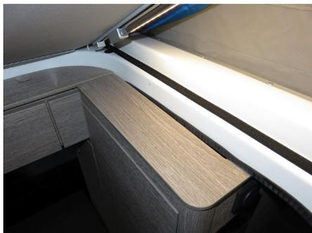
Als nächstes muss der vordere braune Kunststoffwinkel abgeschraubt werden. Er hat zwei Nasen, die in die Abdeckung eingesteckt sind, deshalb müssen alle vier Schrauben gelöst werden. Andernfalls kann die Abdeckplatte nicht vorgezogen werden. Der hintere Kunststoffwinkel ist nur mit der Abdeckung verschraubt und muss nicht entfernt werden. Sollte der hintere Winkel doch mit der vorderen Blende des Schrankes verschraubt sein, dann diese Verschraubung ebenfalls lösen.
