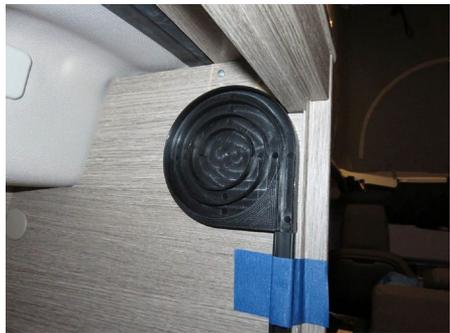
Die Rolltür auspacken und mit der Griffleiste nach unten vollständig in die beiden Spiralen einschieben. Für einen leichteren Lauf der Rolltüren vorher die Kassettenspiralen am besten mit etwas Silikonspray einsprühen.
