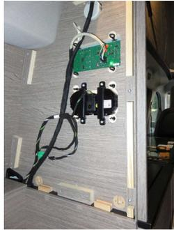
Anschließend die Trennwand wieder einsetzen. Am einfachsten geht das, wenn Sie von oben beginnen. Es sollte jetzt kein oder nur noch ein sehr geringerer Absatz fühlbar sein. Insbesondere dort wo später die Schiene aufgeklebt wird, sollte möglichst kein oder weniger als 0,3 mm Absatz sein. Bei Bedarf etwas Klebeband (nicht im Lieferumfang enthalten) auf die Holzleiste kleben (siehe Bild bei der kleinen Leiste rechts unten).
