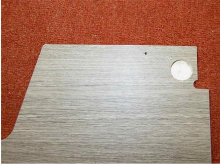
Haben Sie keinen Bohrer zu Hand, dann nur die Stelle markieren und etwas einstechen. Nutzen Sie die Schraube aus dem ausgebauten Korpusverbinder, sie ist selbstschneidend und kann auch ohne Vorbohren eingeschraubt werden. Wenn Sie so vorgehen, dann darf vor dem Eindrehen kein Abstand zwischen Trennwand und Holzblock sein weil durch das Gewinde in Trennwand und Holzblock diese nicht zusammen gezogen werden können.
