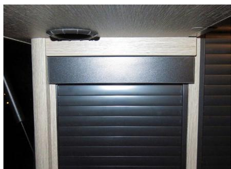
Laufen die Rolltüren schwer und lassen sich nur mühsam vollständig öffnen, dann hilft i.d.R. etwas Silikonspray. Einfach oben in beide Schienen etwas Silikonöl einsprühen und die Rolltüren mehrfach schließen und öffnen. Den Vorgang wiederholen damit das Silikon bis in die Kassettenspiralen gelangt. Idealerweise schon bei der Montage die Kassettenspiralen einsprühen.
