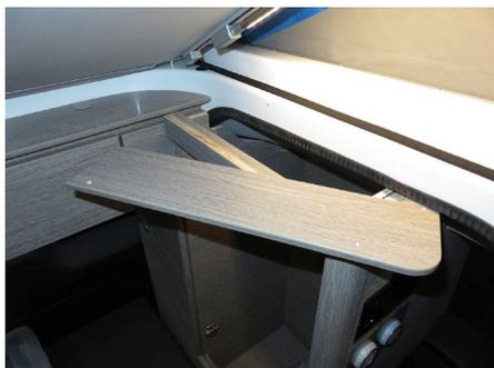
Jetzt die Abdeckung links anheben um den Winkel über die Frontblende zu heben und die Abdeckplatte unter dem Dach hervorziehen. Einfacher geht das in einer Drehbewegung.
