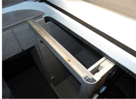
Prüfen Sie, ob es zwischen Trennwand und dem Holzblock auf der rechten Seitenwand einen Spalt gibt, siehe Bild rechts oben. Das darf später nicht sein.
